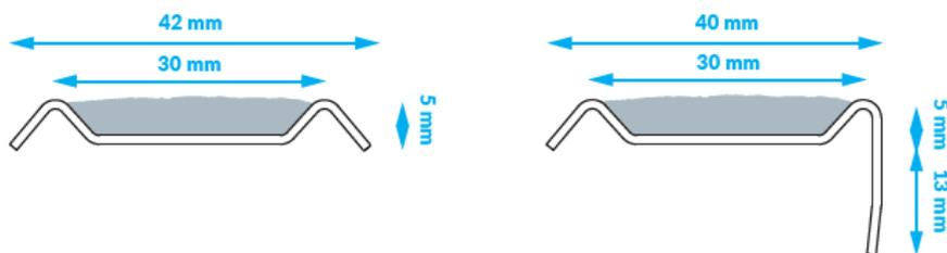
Les **GECKO INOX GT** sont pré-percés tous les 20 cm et de diamètre 6 mm.
