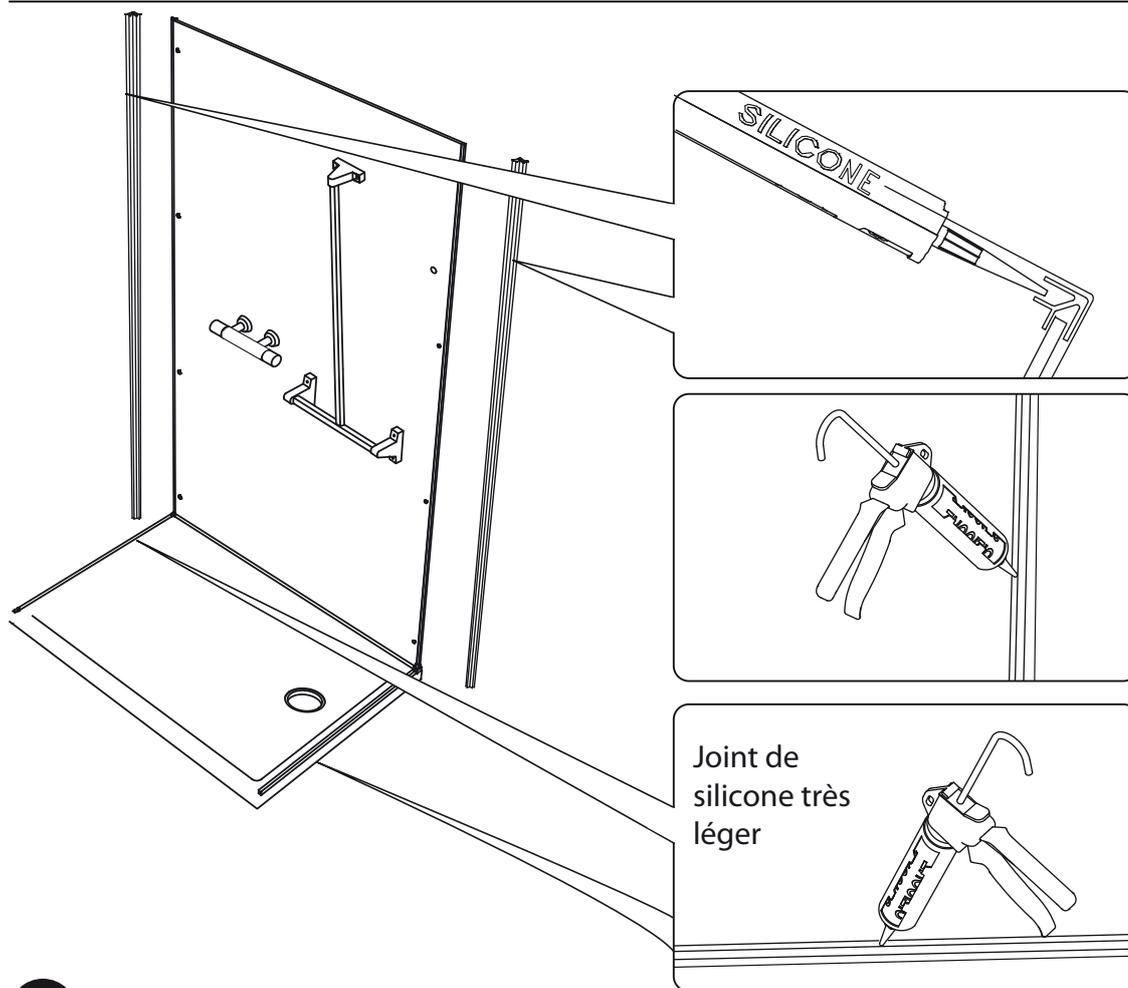
Mettre suffisamment de silicone dans le profilé d'angle pour le coller sur la paroi et assurer l'étanchéité
